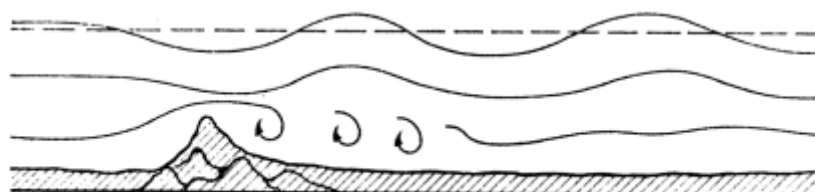
Rys. 18. Schemat powstawania ruchu falowego powietrza
